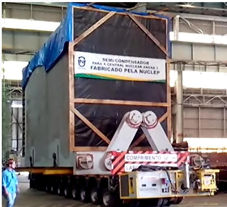
6.2 Semicondensador juntamente com a travessa de içamento sobre uma linha de eixo
