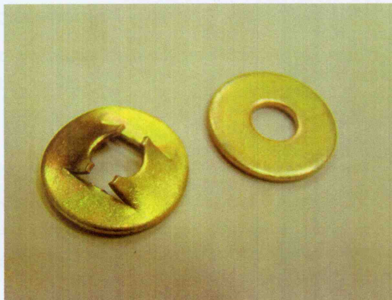
Figura 8 – Detalhe do conjunto trava-arruela de fixação desprendido durante ensaio de impacto do visor superior da porta
