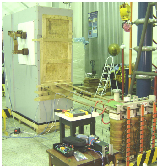
Fig. 03 – Cubículo no ensaio de elevação de temperatura.
