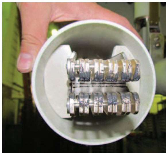
Fotografia 3 e 4: Detalhe dos contatos de inserção e extração do disjuntor após as aplicações de corrente no circuito principal.
