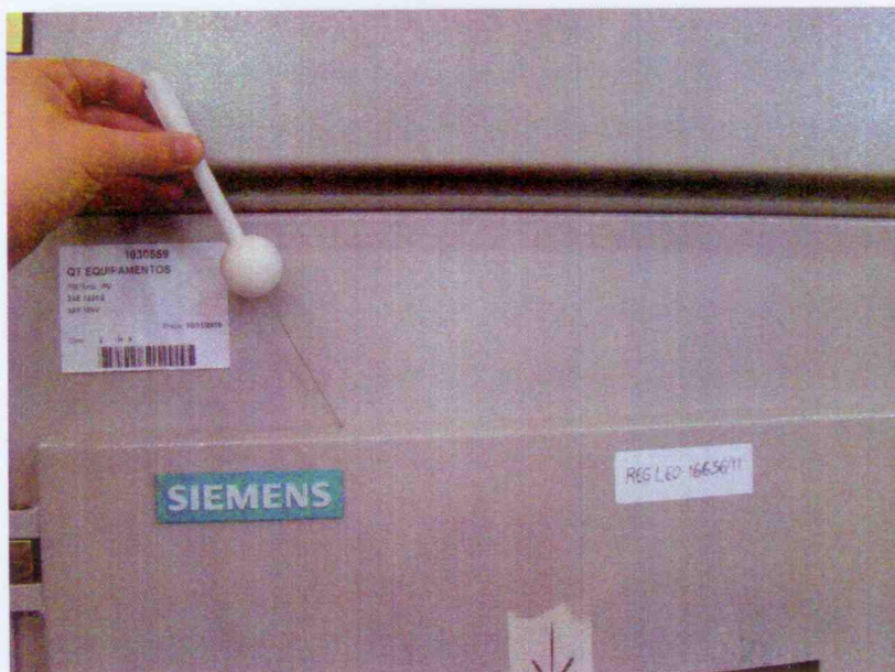
Figura 6 – Detalhe da porta central sem penetração da haste Ø 1mm
