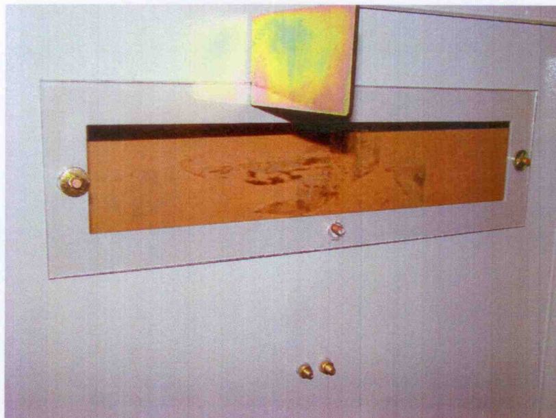
Figura 6 – Detalhe interno do visor superior da porta frontal após ensaio de impacto
