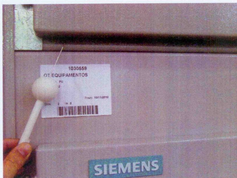
Figura 7 – Detalhe da porta superior sem penetração da haste Ø 1mm
