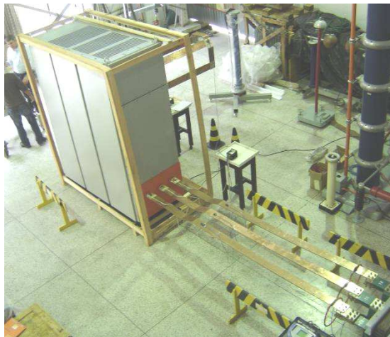
Fig.02 – Cubículo no ensaio de elevação de temperatura.
