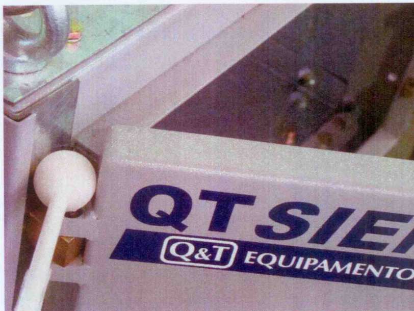
Figura 10 – Detalhe de um ponto de penetração da haste Ø 1mm detectado durante o ensaio com a porta frontal superior fechada (Vide nota 5.3)
