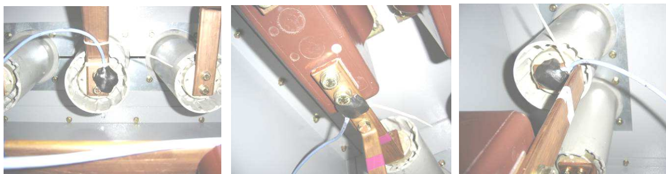
Fig.03 – Localização das sondas T_4 , T_6 , e T_7 , respectivamente.
