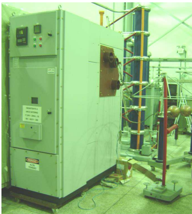
Fig.06 –Cubículo no ensaio de impulso atmosférico.
