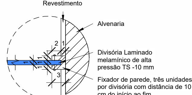
DET.Box Laminado - Ligação Laminado e Parede 1 : 5
