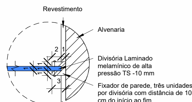
DET.Box Laminado - Ligação Laminado e Parede 1 : 5
