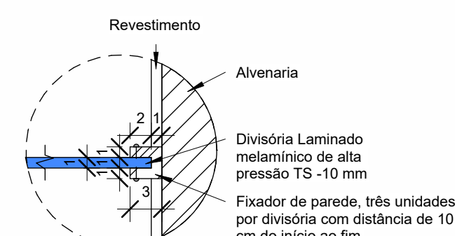
DET.Box Laminado - Ligação Laminado e Parede 1 : 5
